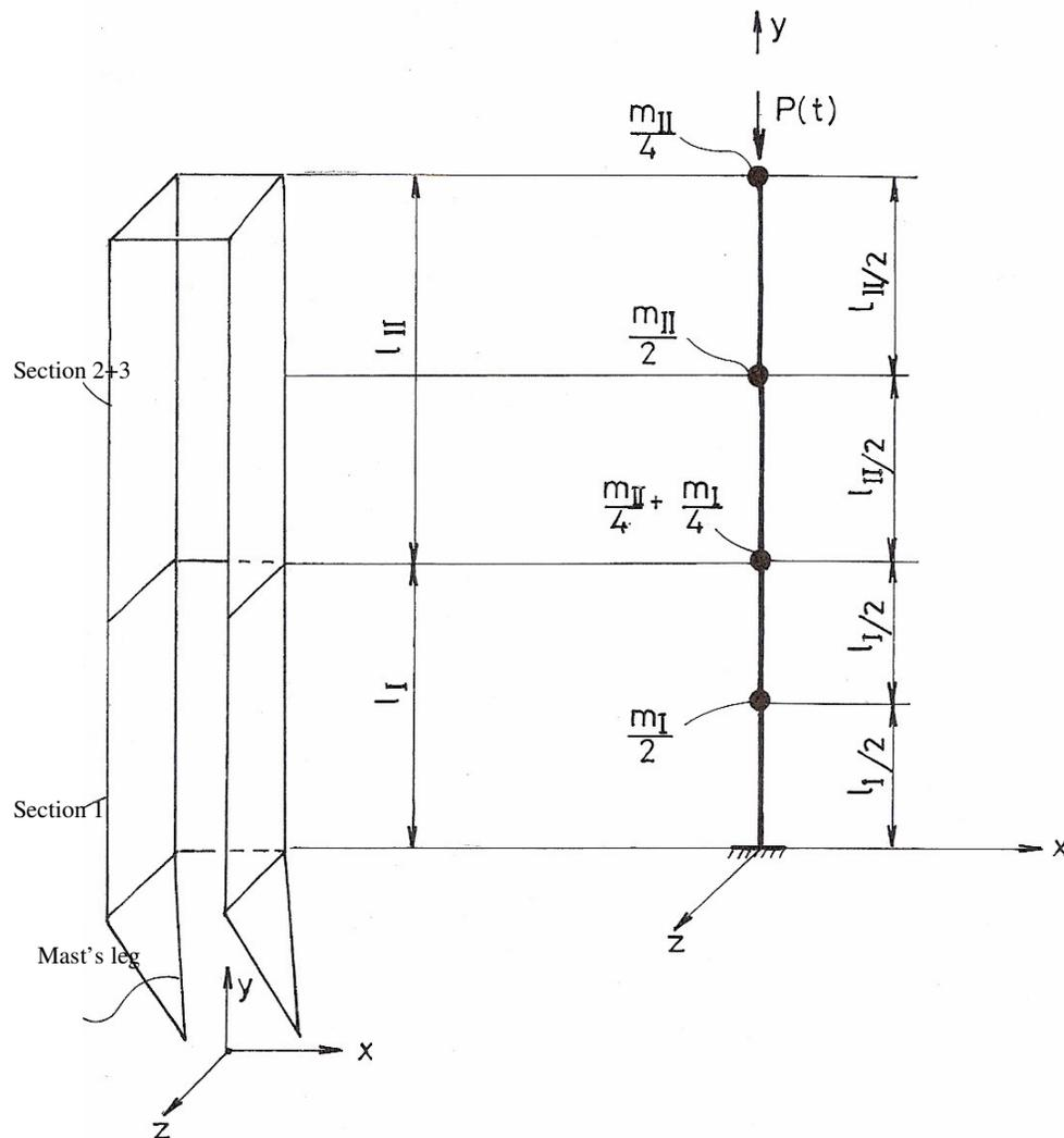
Fig. 1. MU200 mast schema
