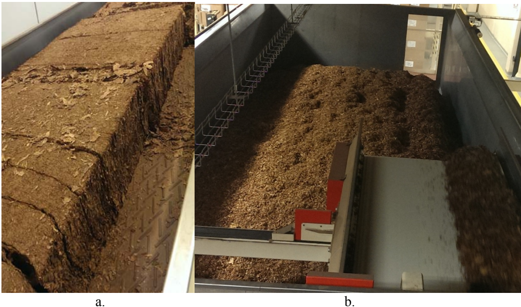
Fig. 2. a. Tobacco slices on weighing belt; b. Tobacco storage in mini silos
